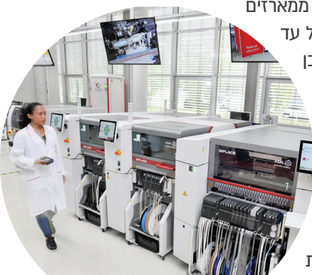
מכונות ההשמה החדישות תוצרת SIEMENS דגם SX1 ו-SX2 שהותקנו במפעל ניסטק בכ"ת
