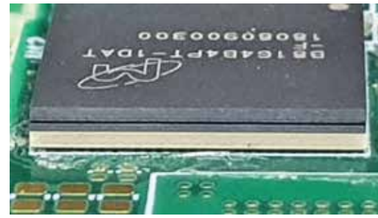
טכנולוגיית POP של רכיב על גבי רכיב שהורכב במפעל ניסטק גולן בקצרין
