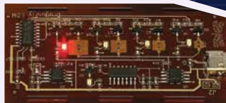
מעגל אלקטרוני רב שכבתי שהודפס במכונת תלת מימד של חברת ננו-דיימנשן והורכב בקו הרכבות אוטומטי בחברת ניסטק
